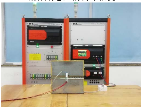
电压骤降和中断
